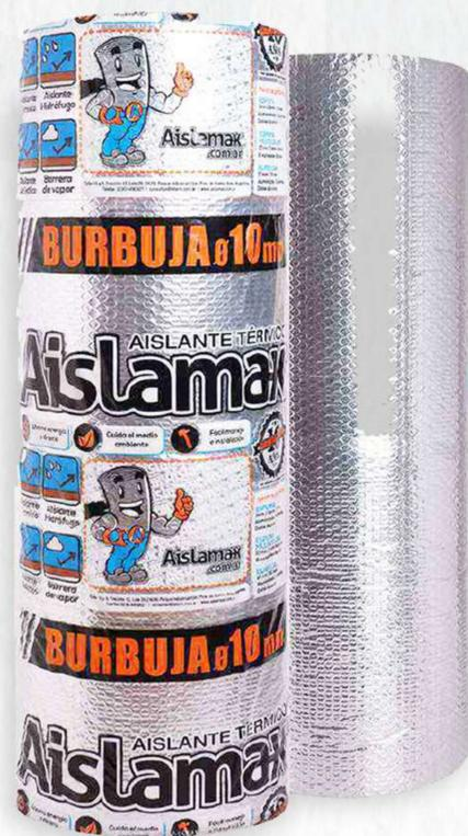
La burbuja con aluminio obtiene un bloqueo de hasta el 97% al paso del calor. Se constituye de una cara reflectiva (foil de aluminio), un encapsulado de burbujas de 10 mm/ 30mm, y en el caso del producto A2 Y AX3 una segunda capa de aluminio (AX2) o polietileno blanco (Ax3).
