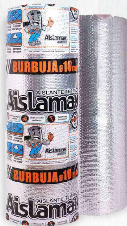
La burbuja aluminizada obtiene un bloqueo de hasta el 90% al paso del calor. Se constituye de tres capas: la primera de una lamina de polipropileno aluminizado, la segunda de un encapsulado de burbujas de 10 mm / 30mm, y por ultimo una tercera capa de polietileno, polipropileno aluminizado o polietileno blanco, según el producto
