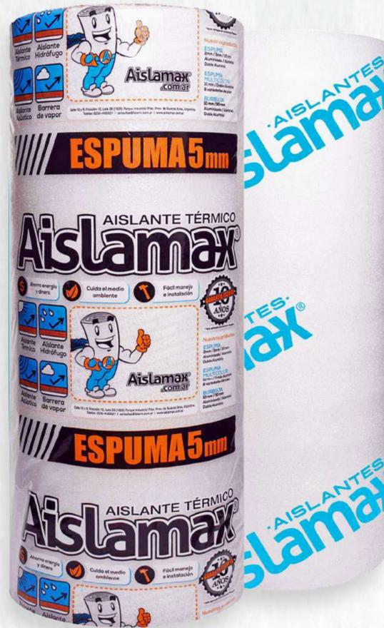
Es un producto a base de espuma de polietileno de baja densidad de celda cerrada, presentado en espesores de 2mm, 5mm y 10 mm. La celda contiene aire estanco, logrando así mantener su baja conducción del calor, impidiendo que la misma entre en sus celdas. Tiene una conductividad térmica baja e inalterable de 0,035 W/m.K
